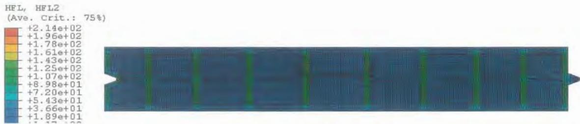
**Fig. 3. Distribución de flujo de calor (W/m²)**
