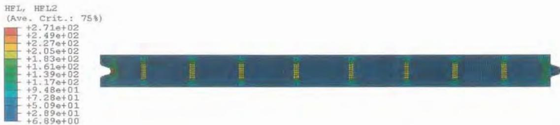
**Fig. 3. Distribución de flujo de calor (W/m²)**
